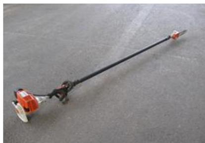
Der Werkhof hat für das Zurückschneiden der Pflanzen entlang von Strassenrändern einen Hoch-Entaster der Marke STIHL HT 131 angeschafft. Das Gerät kann zu Fr. 20.— je Liter Kraftstoff auch gemietet werden. Die Teleskopstange verfügt über eine Länge von 270-390 cm, damit wird die Baumpflege vom Boden in bis ca. 5 m Höhe möglich.
